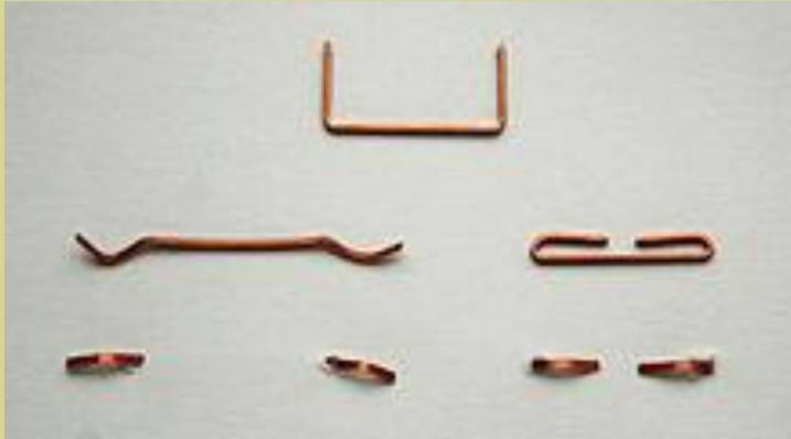
Verkupferte Heftklammer (oben); Heftklammern nach offenem und geschlossenem Heften von der Seite und auf der Rückseite des Heftgutes.
