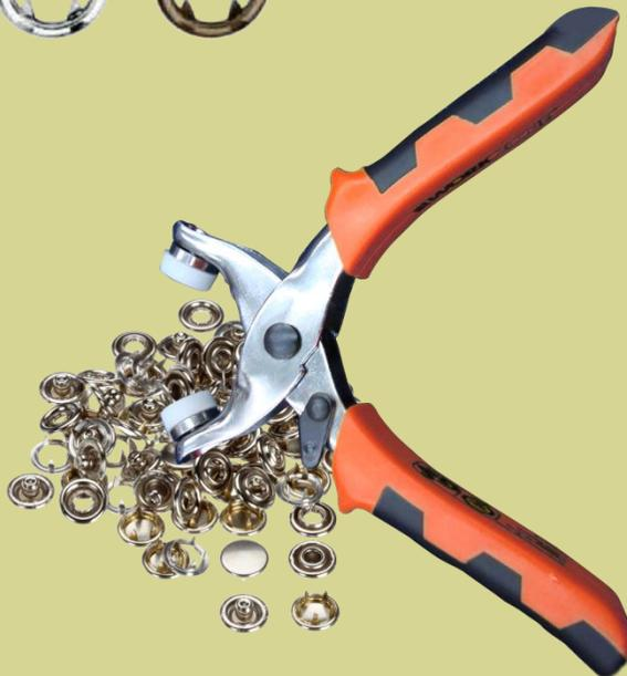
Nun wird das Oberteil in die passende Seite der Zange gedrückt (es sollte je nach Zange, in der Zange von alleine halten). Das Unterteil wird in die andere Seite der Zange gelegt; in der Mitte befindet sich der Stoff.
